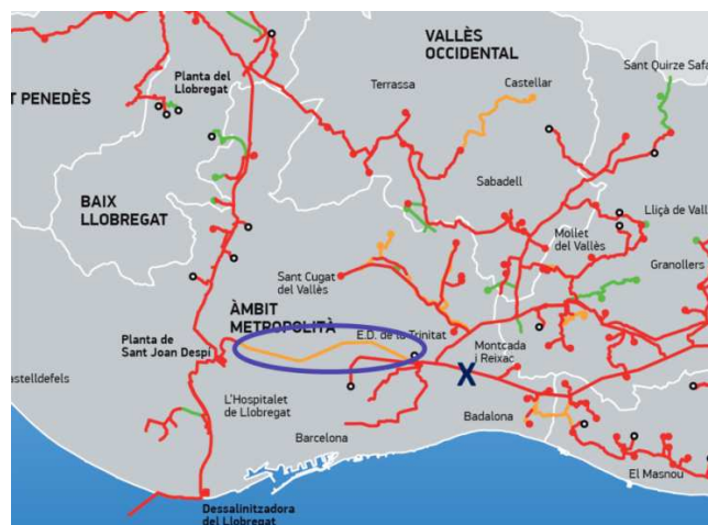
Esquema parcial de la xarxa d'ATLL, remarcada la nova canonada d'interconnexió i assenyalada amb una X la conducció avariada
