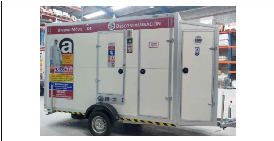
EXEMPLE UNITAT DESCONTAMINACIÓ DE 5 COMPARTIMENTS
