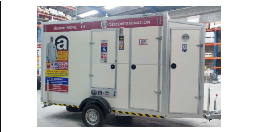
EXEMPLE UNITAT DESCONTAMINACIÓ DE 5 COMPARTIMENTS
